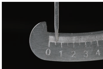
図10 約0.6mmの厚さが確保されている。これ以上薄い場合は切削加工のエラーが現れる可能性がある。
